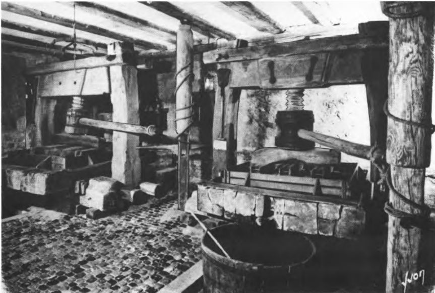
Abb. 59 Einspindelkeltern, sog. Jochpressen, auch Dockenkeltern, von 1654 und 1687 mit Tummelbaum. Museum Unterlinden Colmar.
