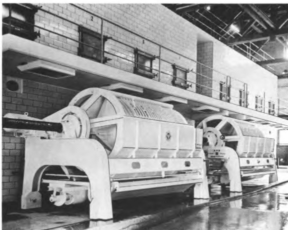
Abb. 120 Horizontal- Spindelpressen von J. Will- mes, HA 4000 mit Außen- spindel um 1960. Werkfoto.
