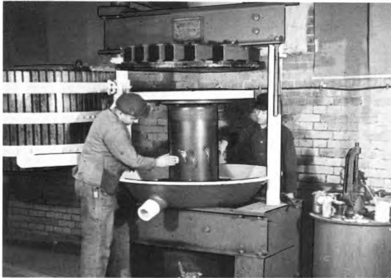
Abb. 101 Abb. zeigt das Reinigen des ausgefahrenen Gußstahl-Kolbens einer Merrem u. Knötgen-Pressen. Später wurden Kolben aus gezogenem Stahl bevorzugt. Geisenheim 1940. Vgl. Abb. 109.
