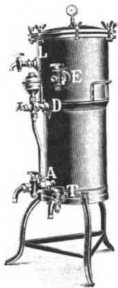
Abb. 20: Asbest-Anschwemmfilter von Th. Seitz. Links Asbest-Anschwemmfilter „Sim- pilon von 1906, Mitte Riesenfilter, Kleines Modell von 1900, rechts Abziehen einer Asbestschicht nach der Filtration von der Gewebefläche eines Filterelementes. Babo u. Mach 1921
