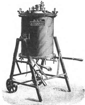
Abb. 19a: Massefilter (Schnellfilter „Ideal“) von L. Lieberich Söhne, aus Neßler-Win- disch, Weinbereitung 1908
